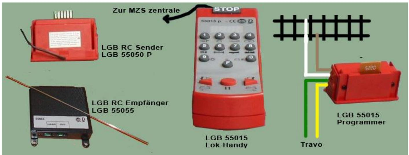
Zum Programmieren wird entweder ein stromloses "Programmiergleis" verwendet oder der Decoder direkt an das Handy über „LGB 55015-Programmer“ angeschlossen:
