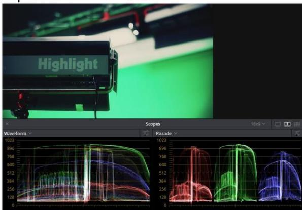
Man kann deutlich sehen, dass bei „Clip Attributes = auto“ Bereiche mit Über- und Unterbelichtung existieren. Bei „Clip Attributes = 0 – 1023“ wird das automatisch bereinigt.
